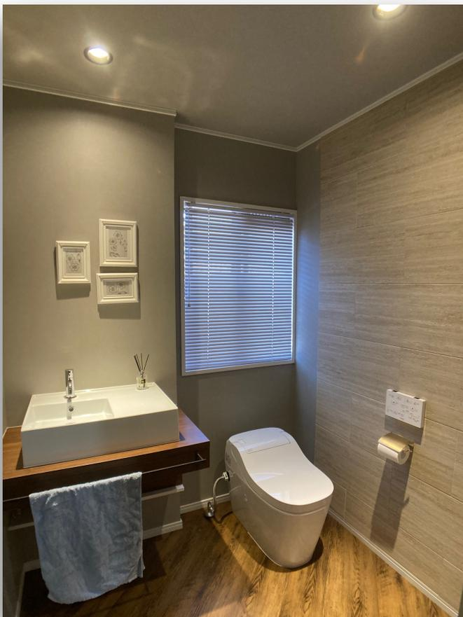
便器はpanasonicアラウーノの上位機種を取り付けています。排水の都度洗剤を使って自動洗浄してくれる人気商品です。湿気対策として、壁一面にLIXILのエコカラットを貼っています。手洗い台は必要サイズに合わせて製作しました。ボウルは輸入商品です。壁紙とエコカラットを調和させるのに苦心しましたが、ヨーロッパアンシックな上品な仕上がりになりました。
